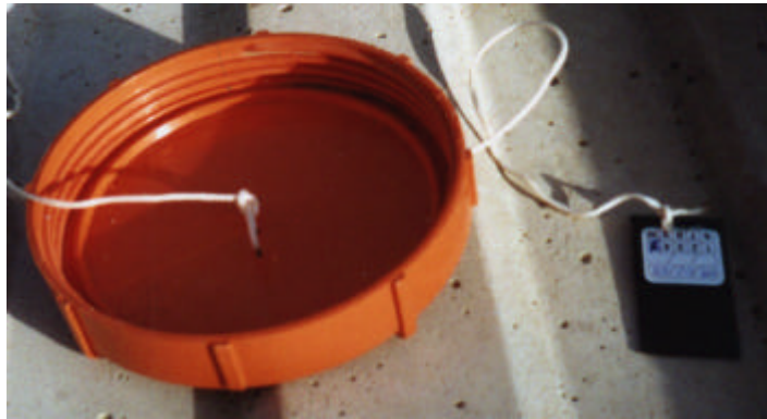
FOTO 4 - Il tappo di chiusura del tubo predisposto con il dosimetro Radon Kodalpa basato su pellicola Kodak LR115
